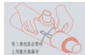
7.1-2 如果选用 U-PVC 专用粘接剂粘合，将 U-PVC 壳宝材料包贴在三通部位，用手扶住或者用橡皮筋捆箍，后将 A型胶水直接点入对接叠合处，用手压住粘合部位 10 秒钟左右即可。下图：
