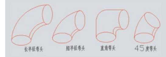
5.2 成品U-PVC壳宝材料弯头的安装
