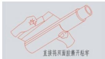
橡皮筋捆箍后撕下双面胶纸皮
