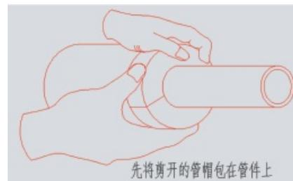
4.2-2 然后用A型胶水打在结合部位，进行初步固定，用手压住粘合部位10秒钟左右即可，等接缝固定后能松开手时，再进行整条接缝补打胶水，一般采用B型胶打。
