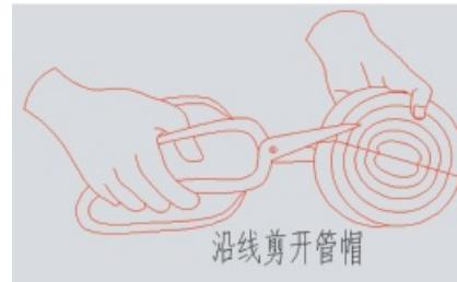
4.2-1 将剪开管帽包贴在管件上，接缝按平整，严实。
