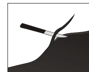
在圆弧板材一侧高端内层切倒角。（这一侧与阀体的侧面相连接）。
