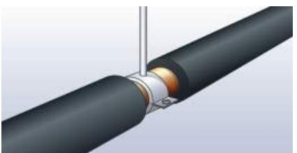
1、把管道保温安装到附近管道支撑的位置。把管道保温的末端和管道用胶水粘接起来。
